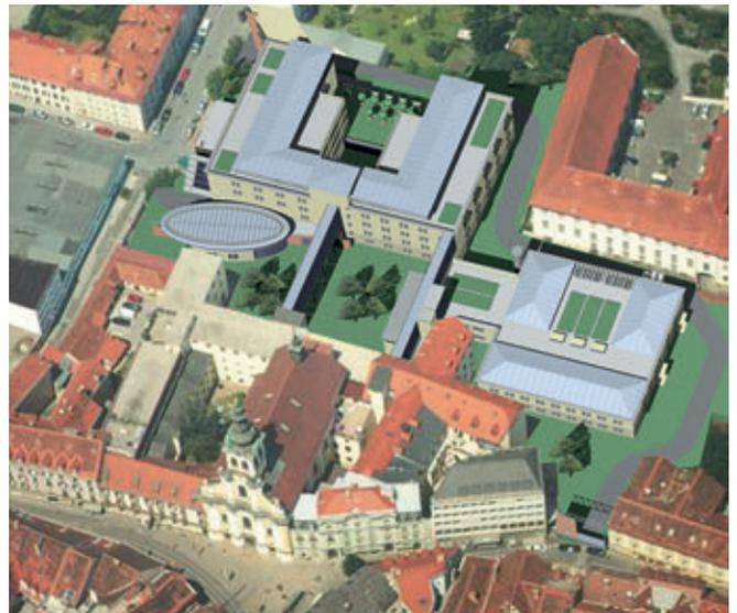
Die Marschallgasse vor dem Umbau 2003–2009 (links) und nach dem Umbau lt. Planung (rechts). Die Bereiche mit den grauen Dachflächen sind gänzlich neu zugebaut. Andere Bereiche im Krankenhaus wurden saniert.
