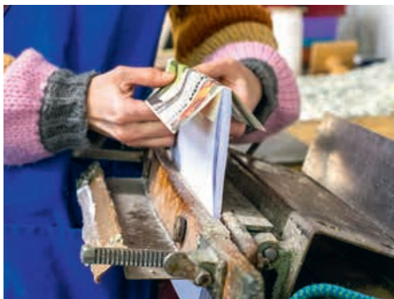
Diese alte Maschine dient zum „Lumbecken“, dem Zusammenkleben der Seiten ohne Fadenheftung.
